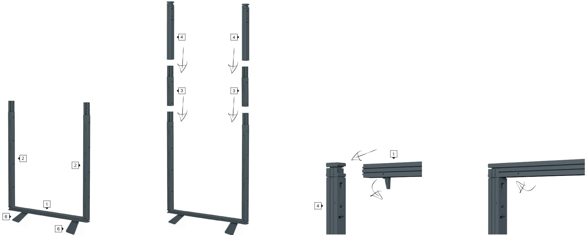
Wiederholen Sie den Vorgang an der anderen Seite des horizontalen Profils. Fügen Sie die vertikalen Erweiterungsprofile und dann die oberen vertikalen Pfostenprofile an. Öffnen Sie die Verriegelungen des oberen horizontalen Verbindungsprofils und verbinden dieses mit den beiden oberen Pfostenprofilen. Schließen Sie die Verriegelungen. Legen Sie die horizontale Stützstange (Brace rod) für den späteren Gebrauch beiseite, sie wird nach Anbringung der Grafik eingesetzt.
