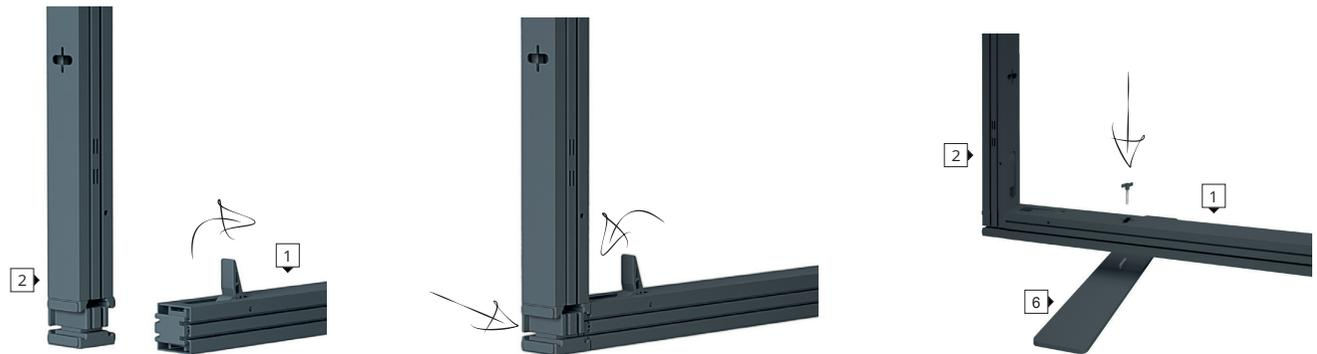
Die Bauteile sind mit Bezeichnungen versehen. Im Lieferumfang enthalten sind horizontale Verbindungsprofile (Horizontal bar **1**), vertikale Pfostenprofile (Vertical pole **2**/**4**), vertikale Erweiterungsprofile (Vertical pole extension **3**), horizontale Stützstangen (Brace rod **5**) und FüÙe **6**.
